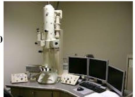
✓ **Microscope électronique à balayage à canon à effet de champ JEOL 6700F** équipé (acquis en 2005):
